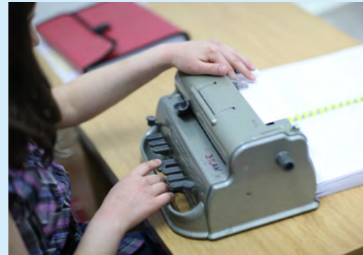
Eine Blindenschriftschreibmaschine kommt mit sieben Tasten aus. Foto: DBSV/Friese
